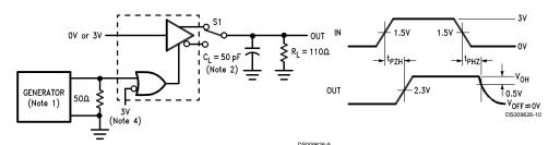
FIGURE 4.  $\rm t_{PZH}$  and  $\rm t_{PHZ}$
