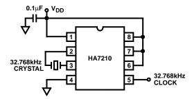
32.768kHz MICROPOWER CLOCK OSCILLATOR
