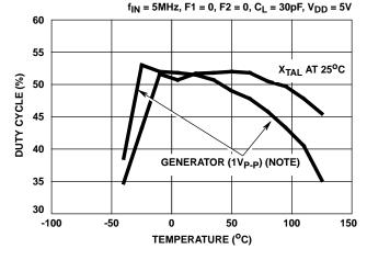
FIGURE 23. DUTY CYCLE vs TEMPERATURE
