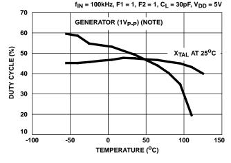
FIGURE 24. DUTY CYCLE vs TEMPERATURE
